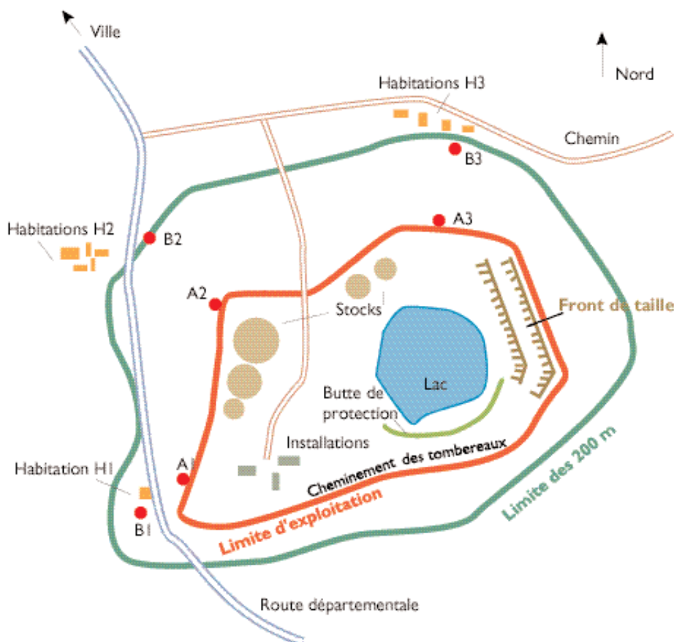
Fig 4 - Schéma de la carrière, de son proche environnement et des points de mesure
